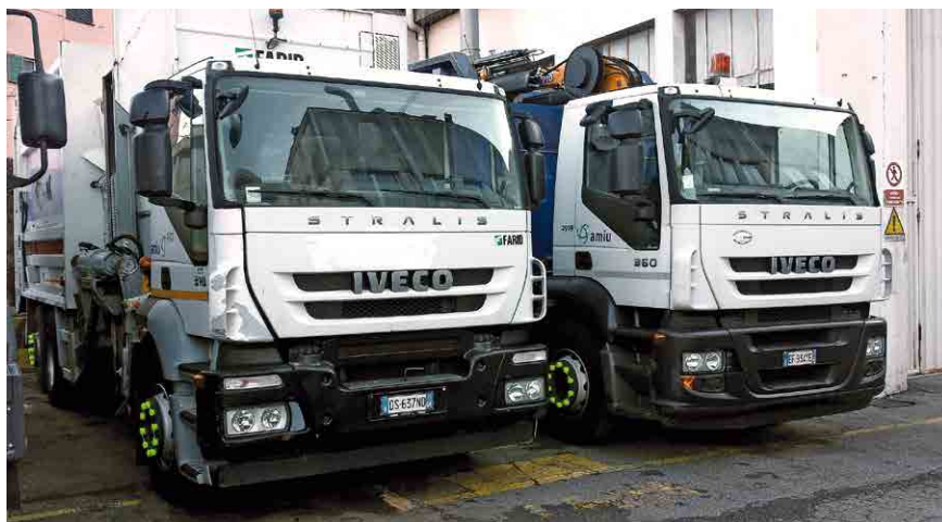
Un esempio di tecnologie low cost: marcatori di serraggio Checkpoint Dustite su veicoli di AMIU Genova.
